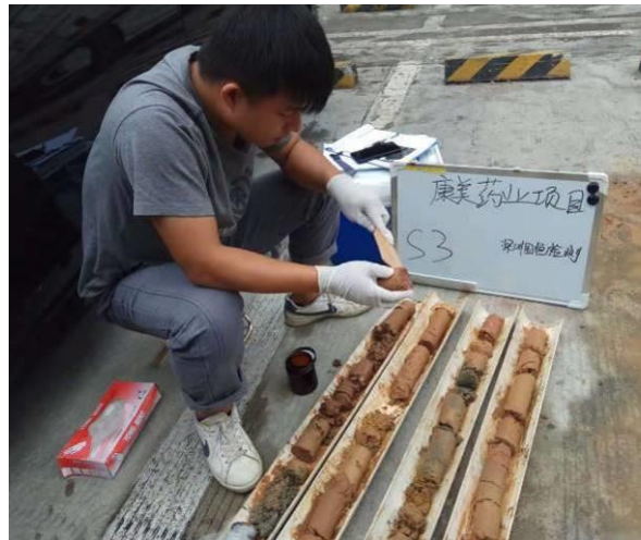
S3 土壤采样照片(采用木铲采样)
