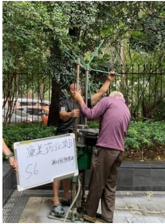
S6 土壤钻孔照片
