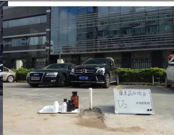
U2 地下水采样成品照片
