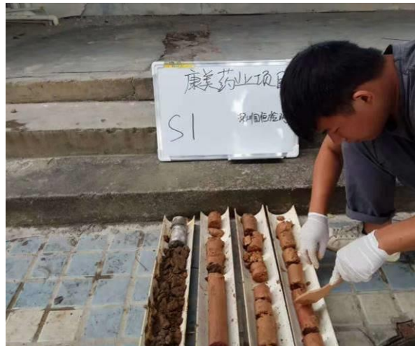
S1 土壤采样照片(采用木铲采样)
