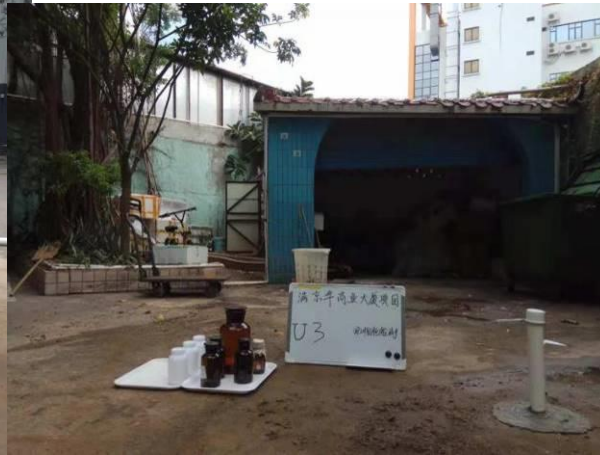
U3 地下水采样成品照片
