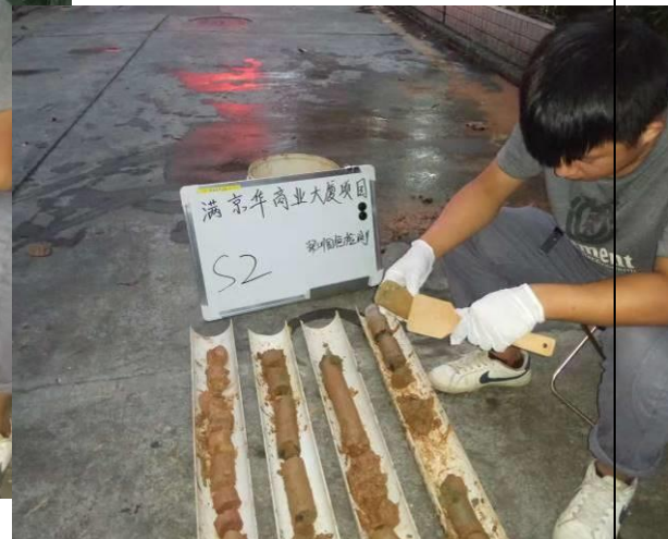
S2 土壤采样照片(采用木铲采样)
